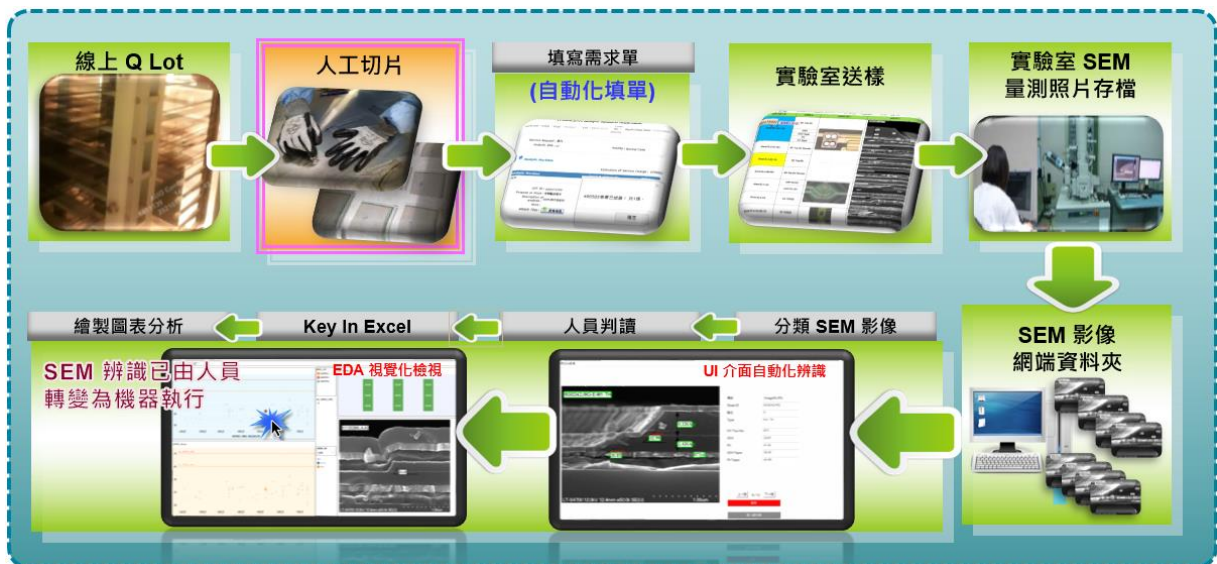
圖 20、SEM 影像智慧辨識流程
