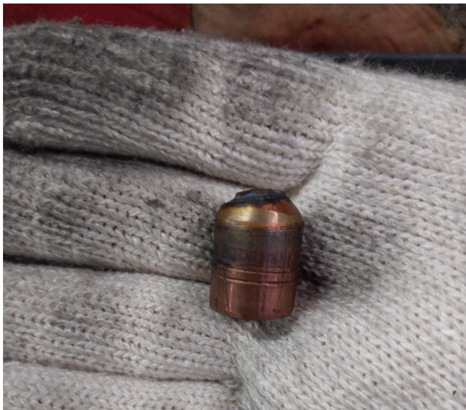
圖 41、不良焊接電極頭(焊渣過多)
