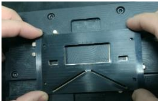
圖 9、將 ABS 板依據四周定位及定位 PIN 貼附
