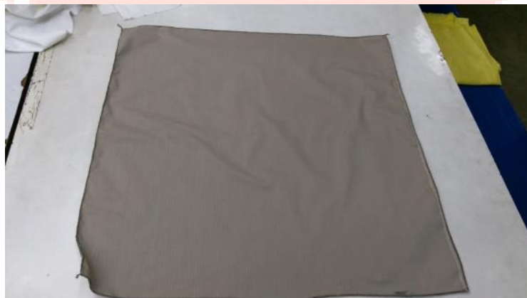
圖 18 70*70 縮率測試布樣
