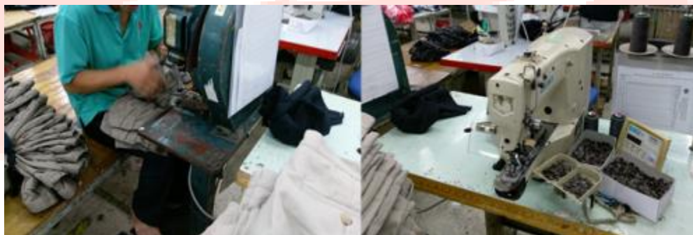
圖 222 釘扣作業與機台
