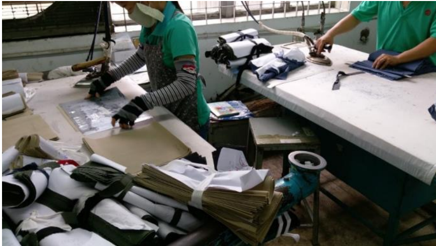
圖 224 現場整燙作業
