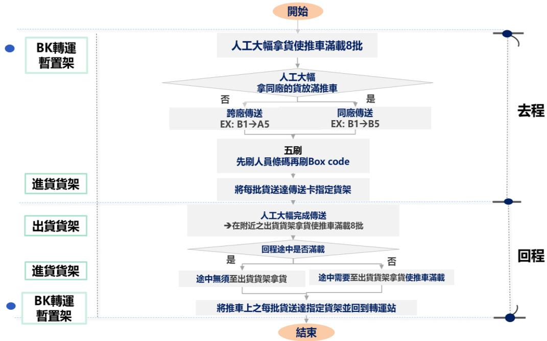
圖 32 MMHS(人工大幅)物料傳送流程圖
